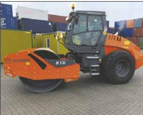
**Valsetog fra Hamm, H13i**, er til jer der har brug for at kunne komprimere eksempelvis sand, jord eller grus ned i en dybde på 60 cm. Hamm H13i har et fantastisk udsyn til maskine og byggeplads og 3-punkt knæleddet giver fremragende trækraft og terrænmobilitet. Valsetoget har en stigningsevne med/uden vibration 52/57% og kan køre trinløs op til 12 km/t. H13i har en valsebredde på 2,14 m. Tromlen vejer 12,86 tons. Valsetoget har en totalhøjde med kabine på 3,037 m og en total-længde på 5,960 m.
